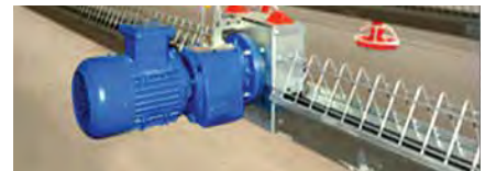
Узел привода системы подачи подвесных цепей
